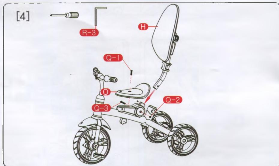
1. Установите спинку сидения (Н) в отверстие на раме и затяните болтом М6\*65 (Q-3) и гайкой М6 (Q-2).
