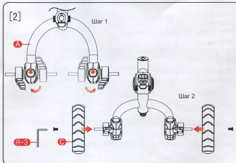
1. Нажмите на кнопки механизмов задних колес и установите их во внешнее положение.
