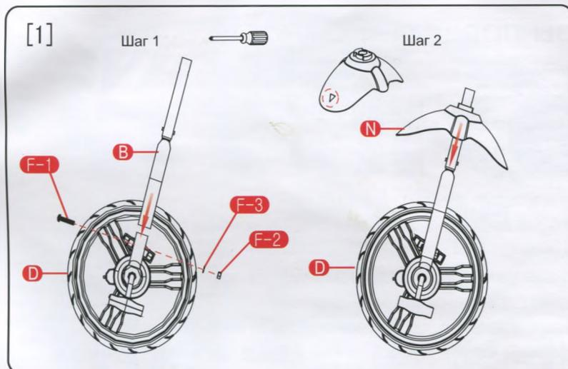
1. Установите вилку (B) в переднее колесо (D) и зафиксируйте болтом M6X30 (F-1), гайкой M6 (F-2) и шайбой 6 мм (F-3).
